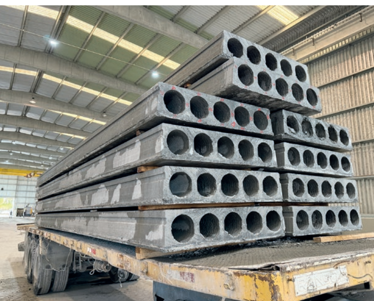
Pannelli alveolari a 5 fori prodotti con la macchina Extruder EVO2 di Nordimpianti
