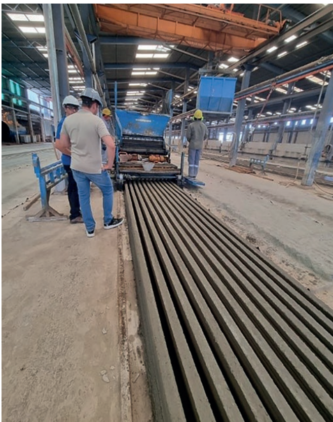
Produzione di travetti a I da 210 mm di spessore con la macchina Slipformer di Nordimpianti
