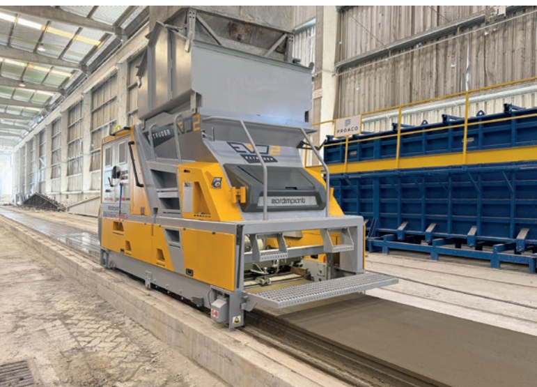
Finitura con la macchina di getto Extruder EVO2 di Nordimpianti
