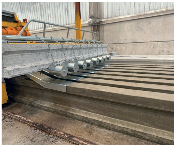
Travetti a I prodotti dalla macchina Slipformer
